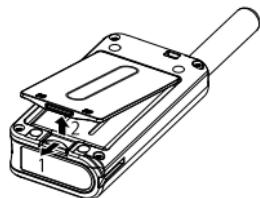
**2** Heben Sie den Akku und seine Verpackung vom Transceiver ab.
