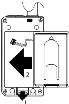
**6** Setzen Sie den Batteriefachdeckel wieder über den Akku.
