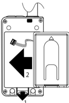
**6** Replacez le couvercle du bloc-piles par dessus la bloc-piles.
