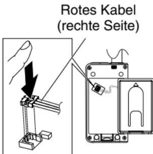
**5** Ziehen Sie den Akku-Lösehebel und setzen Sie dann den Akku in der richtigen Position ein.
