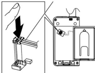
**4 Steek de stekker van de nieuwe batterij in de PCB-aansluiting en druk omlaag.**
