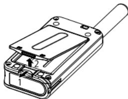
**2** Levante la batería y su paquete y sáquelos del transceptor.
