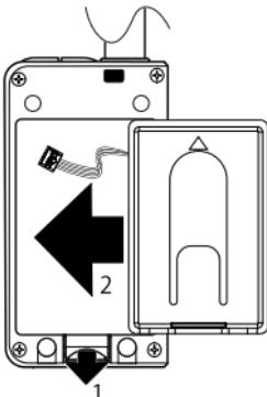
**6 Plaats de batterijafdekking terug over de batterij.**
