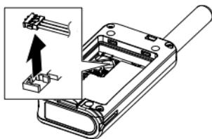
**3** Retire la batería usada de su paquete e inserte la batería nueva.
