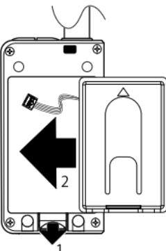
**6** Vuelva a colocar la cubierta de la batería sobre la batería.
