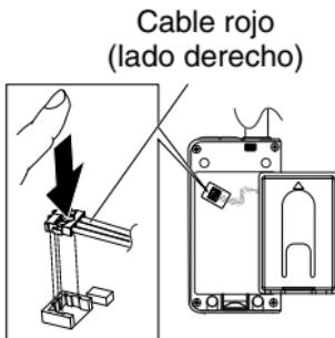
**5** Tire del pestillo de la batería hacia atrás y luego inserte la batería en su lugar.
