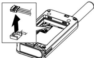
**3** Nehmen Sie den alten Akku aus der Verpackung und setzen Sie den neuen Akku ein.
