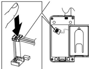
**4** Premendovelo in posizione, collegare il cavo del nuovo pacco batteria al connettore del circuito stampato.
