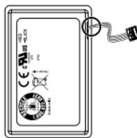
**4** Inserte el conector de la batería nueva en el terminal PCB haciendo presión hacia abajo.
