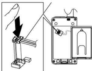
**4** Insérez le connecteur du nouveau bloc-piles sur la prise de la carte de circuit imprimé en faisant pression dessus.
