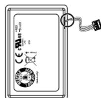
**4** Setzen Sie den Stecker des neuen Akkus in die Leiterplattenklemme, indem Sie ihn eindrücken.
